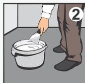
**2** Перед началом работы клей тщательно перемешайте. При приготовлении строительных растворов клей добавляйте в воду перед загрузкой сухой смеси в количестве не более 30% от общей массы.
